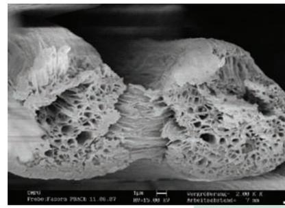
Fig. 34. Fibra Lyocell cu incorporare directa a PCM-ului
