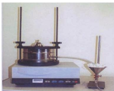
Fig. 54. Echipament pentru determinarea porozitatii
