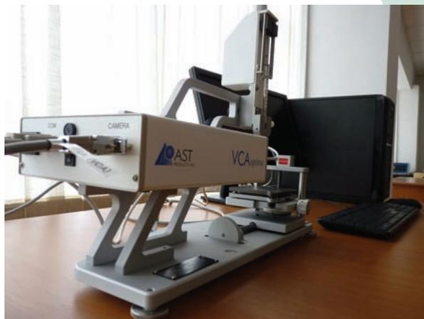
Fig. 97. Echipament pentru determinarea unghiului de contact
